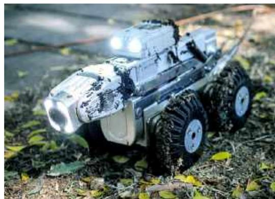
Carro-robô vistoria tubulações em busca de trincas, infiltrações e obstruções
