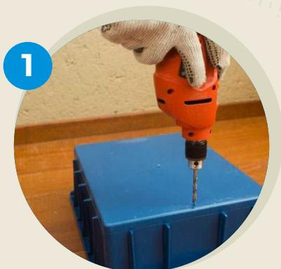
1 Use uma broca de 6 mm para fazer furos na base de duas caixas que ficarão em cima. Elas ficarão sobre uma caixa sem furos
